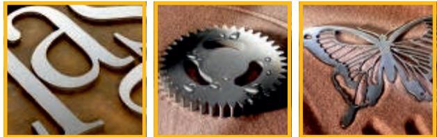
Durch das Abrasivstrahl-Verfahren ist die Bearbeitung verschiedenster Materialien, wie Kunststoffe, Plaste oder Metalle möglich.
